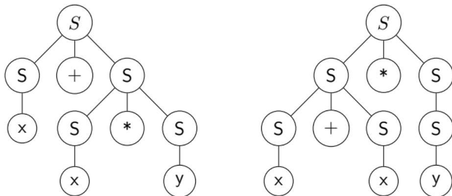
Der erste Baum führt zur Auswertung  $x + (x * y)$ , der zweite zu  $(x + x) * y$ .
